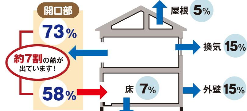
住宅への熱の出入りは、開口部からが半分以上を占めています。壁や屋根、床の対策も大切ですが、開口部の断熱は特に重要なポイントです。断熱性能の高いガラスを使用することで、夏も冬も快適に過ごすことができるのです。
